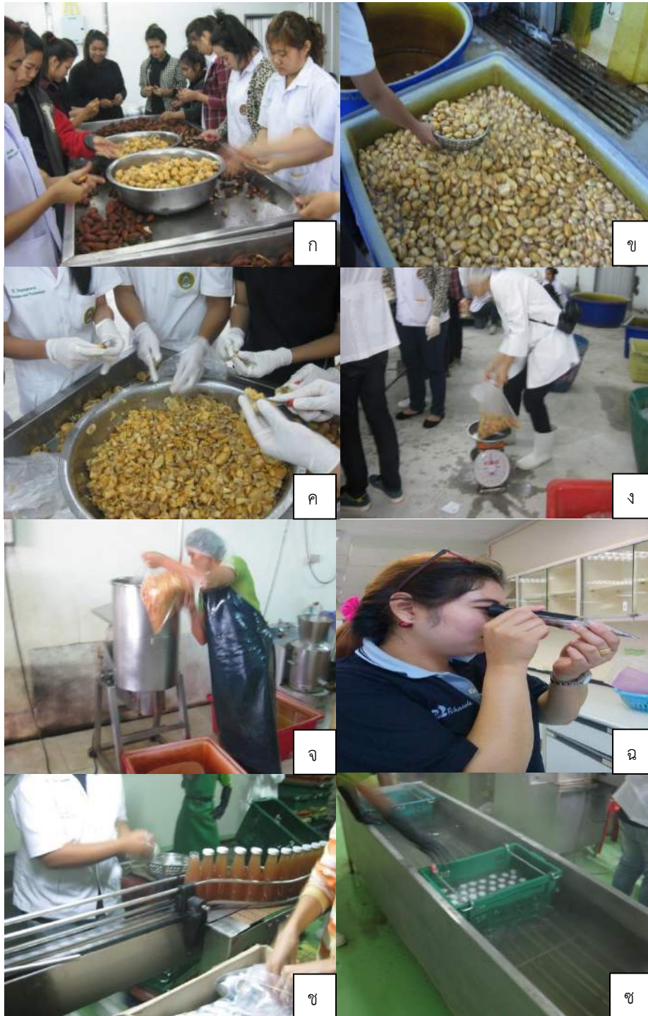
ภาพภาคผนวกที่ 1 ขั้นตอนการผลิตน้ำสละพร้อมดื่ม ก) ปอกเปลือกสละ ข) ทำความสะอาด ค) คำนวณน้ำหนักตอก ก) ชั่งน้ำหนักเนื้อสละ จ) ปั่นเนื้อสละ ฉ) ปรับความหวาน ช) บรรจุลงขวด ซ) ทำให้เย็น
