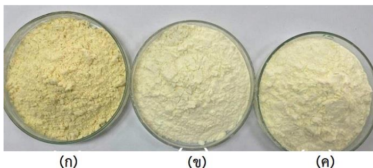
ภาพที่ 2 ลักษณะผงส้มจี๊ดที่ผ่านการทำแห้งแบบพ่นฝอย โดยใช้อุณหภูมิลมร้อนขาเข้าที่ 170 องศาเซลเซียส และปริมาณมอลโตเด็กซ์ทรินระดับต่าง ๆ (ก) ร้อยละ 10 (ข) ร้อยละ 20 (ค) ร้อยละ 30
